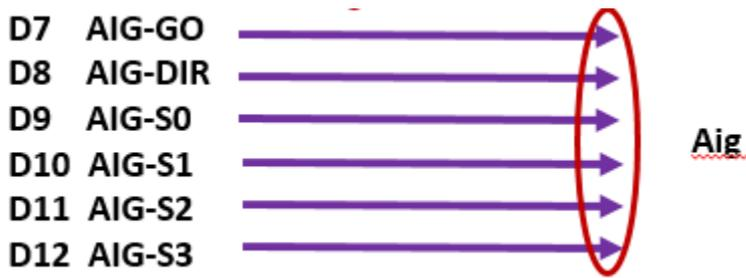
AIG-GO s'active lorsqu'il faut mouvoir l'aiguillage. Sa durée est réglable parmi 125ms, 250ms, 500ms, 1s, 2s, 5s et 10s. AIG-DIR indique la position de l'aiguille (0=position directe, 1=position déviée). S0 à S3 sélectionnent l'aiguillage à déplacer comme suit : numéro de l'aiguillage =  $8*S3 + 4*S2 + 2*S1 + S0$ . Par exemple pour S3=0, S2=0, S1=1, S0=0, ce sera l'aiguillage 2 qui sera sélectionné entre les aiguillages 0 et 15.
